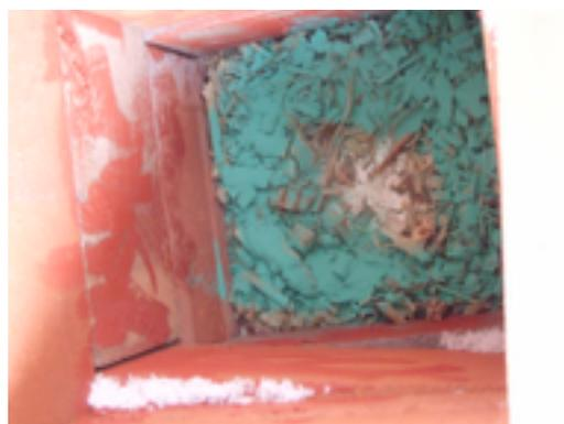
La gazette en brique réfractaire est placée à l'intérieur du four à gaz, avec des copeaux de bois, du carbonate de cuivre et de l'oxyde de fer rouge et enfin du sel. Prêt pour intégrer la pièce, puis couvrir la gazette d'une étagère elle aussi réfractaire
